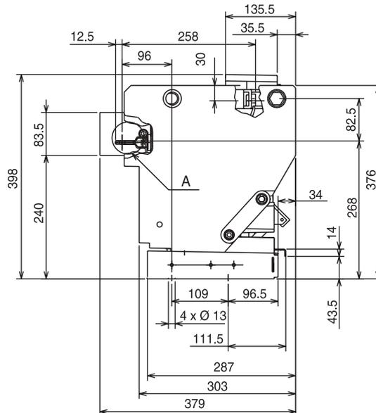
**N.B.** Le dimensioni del contattore fisso tripolare sono valide anche per il contattore fisso unipolare (senza le ampole laterali).
